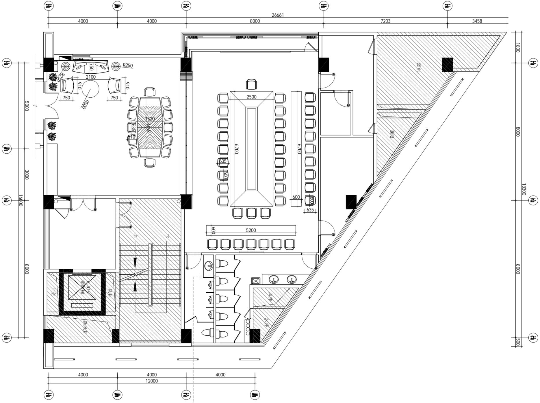
注: 平面图中M-1/M-2/M-3/乙级防火门, 为新做门
