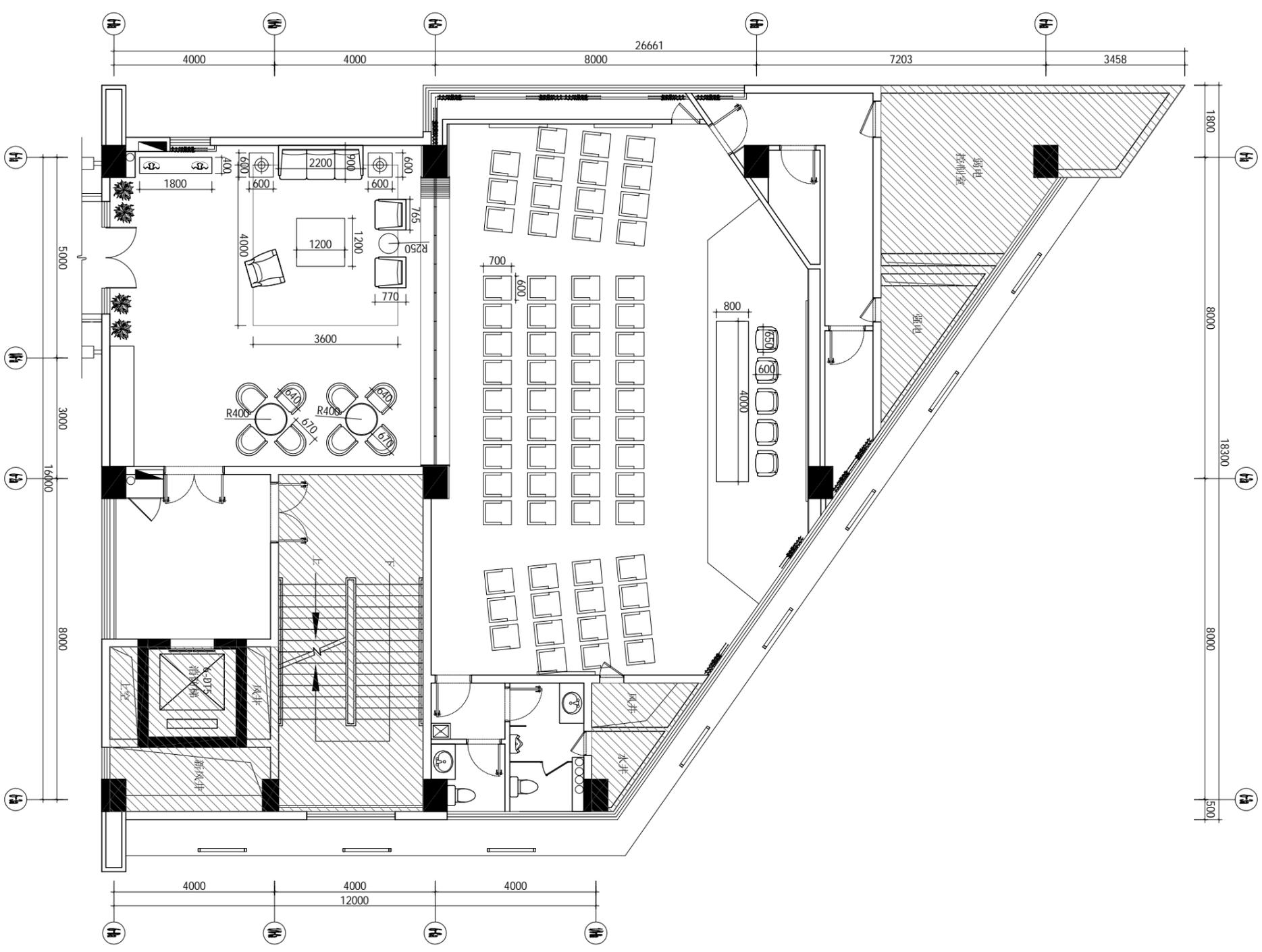
注: 平面图中M-2/M-4/乙级防火门, 为新做门
